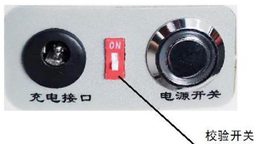
※ 校验仪器：置于 ON 档，长按测试键，持续输出设定电压。
